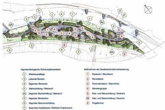
Abb. 5: Ingenieurbio-logische Sicherungsbauweisen und Gewässerstrukturmaßnahmen im oberen Gewässerabschnitt/Quelle: IB Philipp & Partner
