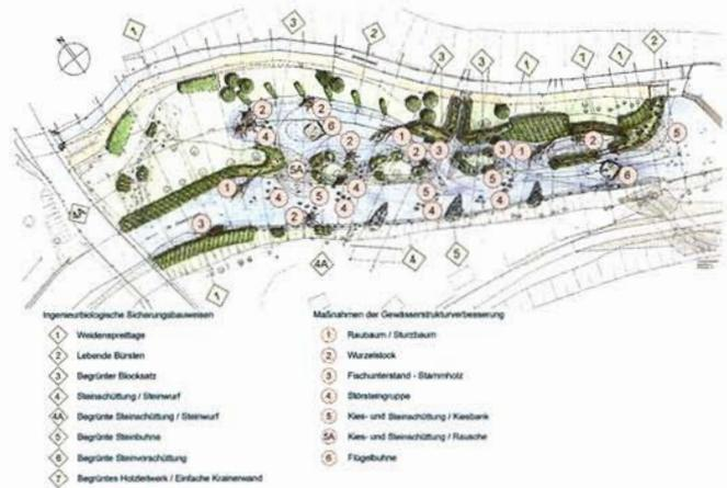
Abb. 4: Ingenieurbio-logische Sicherungsbauweisen und Gewässerstrukturmaßnahmen im unteren Gewässerabschnitt/Quelle: IB Philipp & Partner/Thomas Müller LTV
